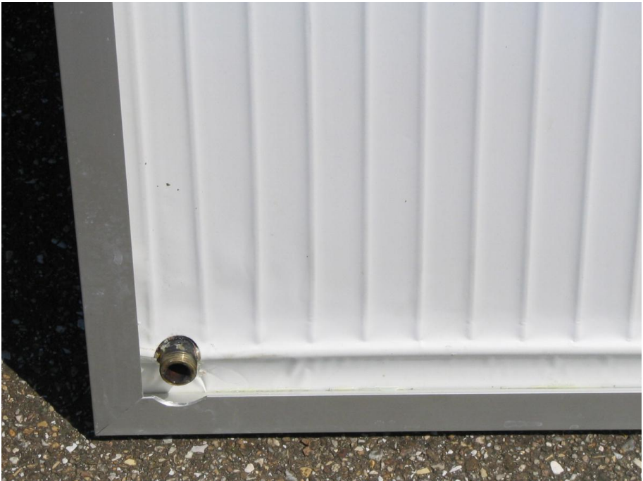
Rückseite einer Photovoltaik und Wärme Kombination: Kapillarrohre und ein Anschluß für die Kühlung.
