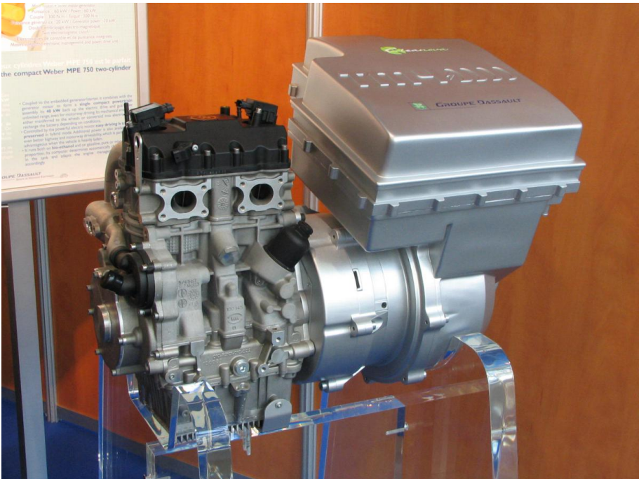
Kombinierter seriell und parallel Hybridmotor vom Renault Kangoo Cleanova II gezeigt auf der EVER Monaco 2007.
