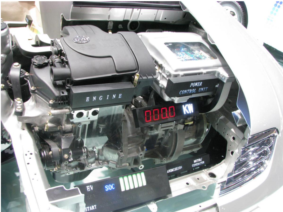
BYD F3DM seriell parallel hybrid System: Links der Verbrennungsmotor, rechts der Motorkontroller, darunter der Elektromotor.
